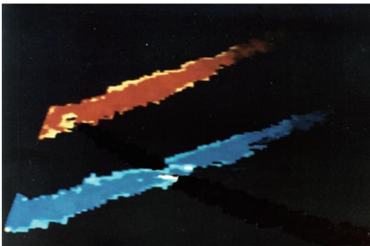
図1：水中に置いた糸ターゲットからのカラードプラ画像。上の糸は右上に、下の糸は左下に動いている。(1982年春)
