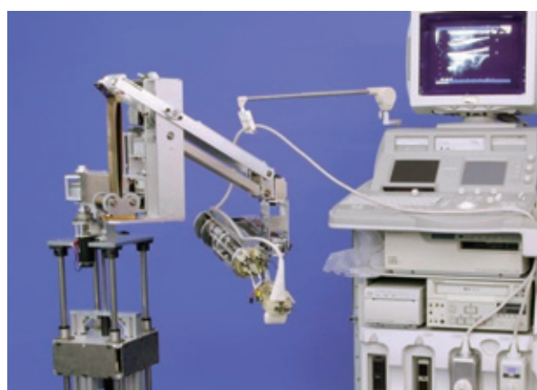
Fig. 1 頸部用プローブ把持ロボット。ぶら下がっている部分が6軸の平行リンクと呼ばれる機構を採用した小型ロボット。ぶら下げている部分はロック可能なフリーアーム
